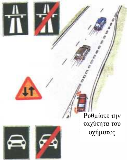
Σχήμα 3.16.1: Είσοδος σε αυτοκινητόδρομο: ρυθμίστε την ταχύτητα του οχήματος.
